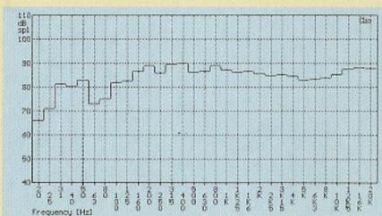
Réponse amplitude/fréquence en tiers d'octave à 1m, dans l'axe et en milieu semi-réverbérant de la System Audio SA 1230. Même remarque que pour la mesure précédente.
