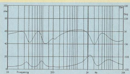
Caractéristique d'impédance en fonction de la fréquence de la System Audio SA 1230. Le module d'impédance est de 4,3 Ω. La fréquence d'accord est située vers 56 Hz.
