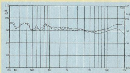
Réponse amplitude/fréquence à 1m, dans l'axe et à 30° dans le plan horizontal, de la colonne System Audio SA 1230. Pas d'accident majeur, mais léger creux entre 2 et 8 kHz.
