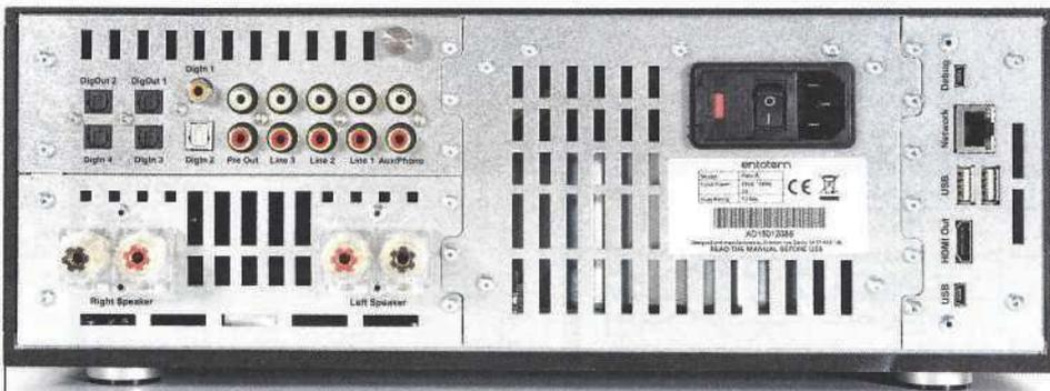
**SERVICE-FREUNDLICH:** Bei der Rückansicht lassen sich die einzelnen Module des Entotem Plato gut identifizieren: Links oben die Vorstufe mit analogen und digitalen Eingängen, darunter die Endstufe, daneben das Netzteil und ganz rechts die Netzwerk-Abteilung.
