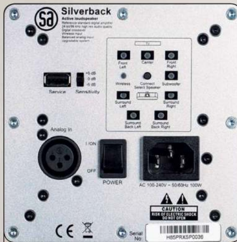
NÄCHSTE STUFE: Die Elektronikmodule der SA Legend 60 Silverback sind schon für den Einsatz in 7.1-Surround-Systemen vorbereitet. Allerdings trat unsere Kombination noch mit dem bereits verfügbaren Stereo Hub an.
