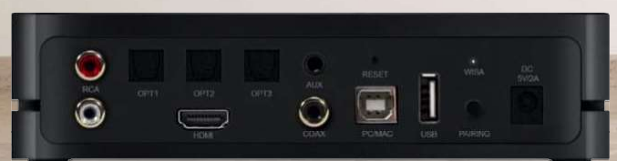
DRAHTLOSER DREH- UND ANGELPUNKT: Unter dem Kunststoffgehäuse des Stereo Hubs verbergen sich vier Antennen, weshalb ein Metallgehäuse nicht in Frage kam. Das kleine Wireless-Modul kann Bluetooth, WLAN und kommuniziert mit den Lautsprechern und der Fernbedienung. Der HDMI-Eingang funktioniert nur in Verbindung mit Ausgängen, die ARC unterstützen. USB-A bleibt Software-Updates vorbehalten.
