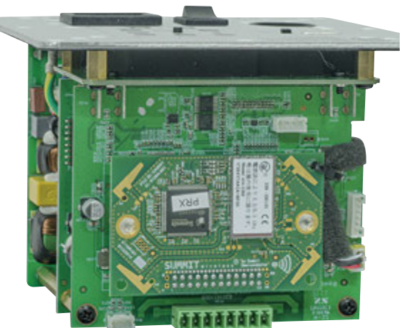
La scheda di controllo si preoccupa di allineare la risposta del diffusore sia nel dominio della frequenza che in quello del tempo.
